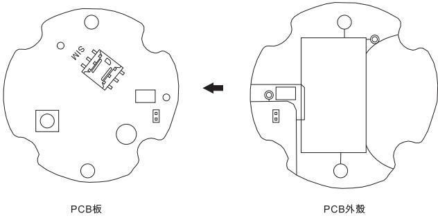
將PCB板翻到有SIM卡槽的一面，按照卡槽提示的方向將SIM卡插入。
