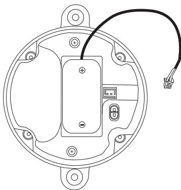
將電池線端子插入電源線口，方向如圖所示。
