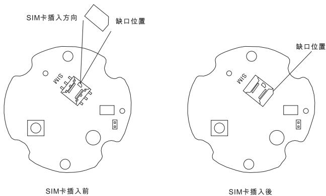
SIM卡安裝完成後，將PCB板裝進PCB外殼，如圖所示。
