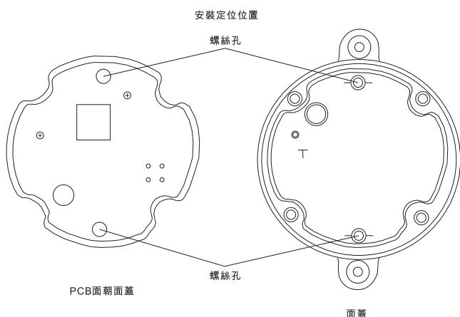
將PCB板外殼裝入面蓋後，PCB板外殼電池位置面是朝外的，將5~6號PCB板外殼固定螺絲擰緊，如圖所示。
