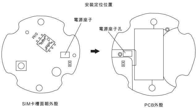
PCB板裝進外殼後，PCB板沒有SIM卡槽的面是朝外的，將7~8號PCB板固定螺絲擰緊，如圖所示。
