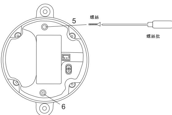
將5~6號固定螺絲擰開後，拿起PCB外殼，翻轉至背面( PCB板 )，用螺絲批分別擰開PCB板上的7~8號固定螺絲。
